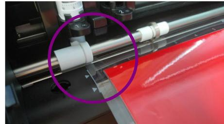
3. Appuyez sur la flèche vers le haut à droite de la machine pour charger le matériau.
