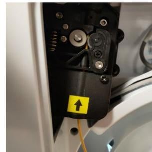
6. Chargez le filament par le bas, en respectant son sens d'enroulement pour un bon déroulement.
