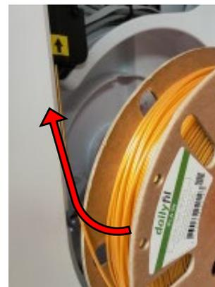
7. Installez la bobine sur le porte-bobine une fois le filament entraîné. Si la bobine est trop grande, utilisez l'adaptateur rouge pour le porte-bobine.
