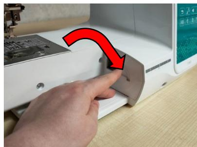
5. Prenez l'unité de broderie et insérez-la au même emplacement que l'unité de couture, en veillant à bien brancher le connecteur de l'unité de broderie dans le port de connexion, jusqu'au bout.
